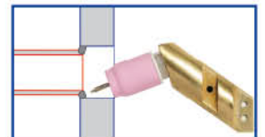
背部管板焊接
